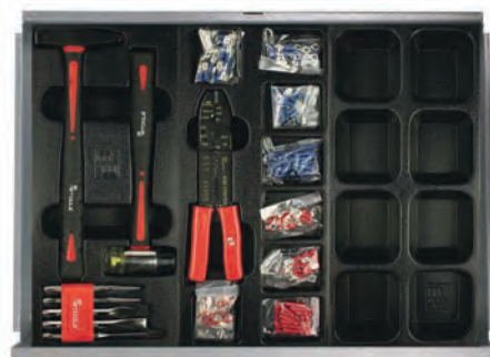
Bandeja 5: Juego de martillos, cincel, buril, punzones, 7 piezas. Juego de terminales y alicates para terminales, 161 piezas. Bandeja con separadores.
