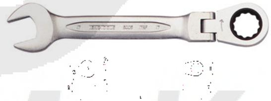
Combinación de estrella plana/llave fija con carraca bihexagonal con articulación flexible a 180°. Mismas dimensiones en los dos extremos, ángulo de inclinación de 13°. Cromo vanadio. Acabado mate.
