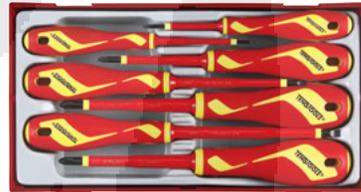
Juego de 7 destornilladores aislados planos, Phillips y Pozidriv fabricados según la norma IEC 60900. Aptos para trabajos en tensión hasta 1000 voltios.
