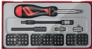
Juego de 74 piezas. Consiste en un destornillador de carraca, extensión flexible de 6", alargadera de 4", escuadra externa 1/4"x1/4" adaptador externo hexagonal, escuadra interna 1/4"x1/4" adaptador interno hexagonal y 69 brocas.
