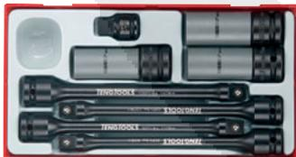
Conjunto de vasos y barras de torsión para apretar las ruedas de los coches. Cuando se alcanza el par de apriete previsto el vaso se detiene mientras el extremo de accionamiento salta hacia atrás a cada golpe. Reduce el riesgo de tornillos rotos o llantas deformadas.
