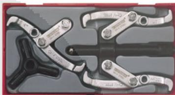
Juego de extractor universal de 3 garras con una pata extra para convertirlo en extractor de dos garras. Con patas reversibles para agarre interior y exterior. Cromo vanadio.
