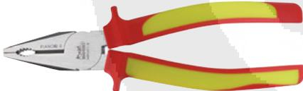
Combinados aislados Mega Bite de gran resistencia. Cromo molibdeno. Ángulo de corte de 80°. Fabricados y certificados de acuerdo a la norma EN 60900. Aptos para trabajos en tensión hasta 1000 voltios AC.
