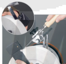
Paso 3: Ajuste de la altura conveniente del soporte de la cuchilla.
