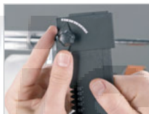
Paso 2: Ajuste con medida de la cuchilla.
