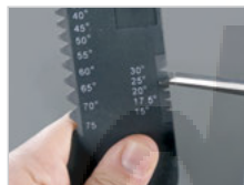
Paso 1: Comprobación y fijación de la cuchilla de afilar.
