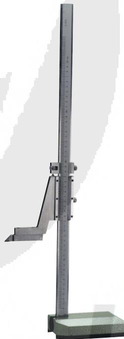
Escala chapada en cromo mate. Graduado en mm. Con excelente tornillo de ajuste. Lectura de pie de rey 0,05 mm. DIN 862.
