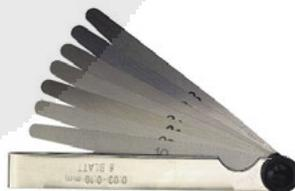
Calibrada. Tolerancia según el DIN 2275. Certificado incluido. Calibrada en dos puntos de medición por lámina. Láminas graduadas en mm. Para medir ranuras, juego de cojinete, etc. Con soporte niquelado, que puede ser cerrado con llave. Longitud lámina 100 mm.
