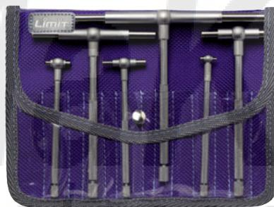
Consta de 2 cilindros de medición de resorte. De acero templado. Bloqueo con tornillo en la parte superior del mango. Se puede leer con un micrómetro.
