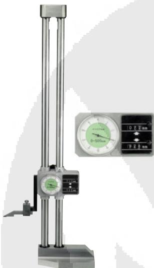
El valor de medición se lee en mm en el contador y en 0.01 mm en el indicador de cuadrante. 1 vuelta aguja=1mm. El contador dual, uno para sumar y otro para restar, se pueden poner a 0 individualmente en posición opcional. Ajuste flexible de altura con el botón situado en la parte trasera. Punta de medición en metal duro. DIN 862.
