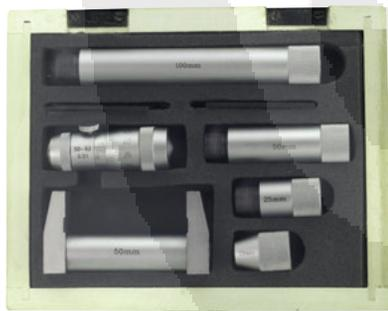
Lectura 0,01 mm. Incluye cabeza de micrómetro y alargos tambor graduado y casquillo chapado en cromo mate. Se suministra con mordaza de ajuste y en caja de madera. DIN 863.
