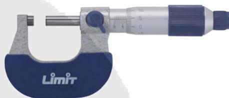
Lectura 0,01 mm. Estructura forjada y escala chapada en cromo mate. Regulador y llave de fijación. DIN 863.
