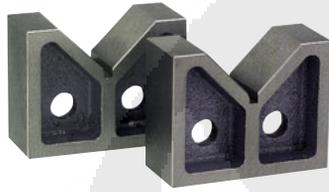
De hierro fundido aliviado de esfuerzos. Fabricados a precisión en pares. Paralelismo entre la base y la ranura en V, máx. 0,03 mm. Ángulo de la ranura en V de 90°.
