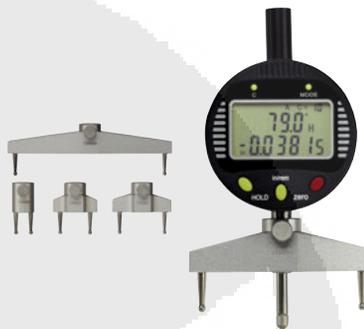
Adecuado para medir el radio de objetos esféricos como piezas de plástico, moldes, planchas, cuerpos de un vehículo, superficies de muebles, tuberías, etc. Medidas tanto en superficies convexas como cóncavas. Instale el indicador de cuadrante en un punto fijo. Poner a cero el indicador de cuadrante contra una superficie plana. Ponga el aparato en la superficie y se lee el valor del radio en el indicador de línea.
