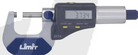
Digital. A prueba de salpicaduras. IP 54. Lectura 0,001 mm. Lectura en mm o pulgadas. Apagado automático después de 5 minutos. Superficies de medición forjadas. Dedal de fricción y dispositivo de bloqueo. DIN 863. Pilas tipo SR 44.
