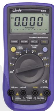
De tamaño reducido y display con iluminación. Mide voltios AC/DC, corriente DC, resistencia, temperatura.
