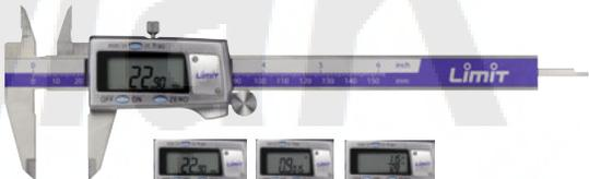
**4 funciones.** Lectura 0,01 mm. Triple lectura: métrica/ pulgada/ fracción pulgada. Acero inoxidable. **Opción de paro automático.** Posición cero en cualquier posición. DIN 862. Pilas tipo SR44.
