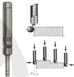
Detector electrónico de bordes. Simplifica el proceso de puesta a punto y el posicionamiento del husillo de la herramienta en relación a la pieza de trabajo ó mesa de la maquina en las fresadoras y taladradoras. Señal de LED y de audio indican el contacto entre el eje y la pieza de trabajo. Fabricado con husillo de precisión, medición con bola de acero que sale lateralmente. Longitud total 157 mm. Precisión  $\pm 0,005$  mm. Batería 2 x 1.5V LR01.
