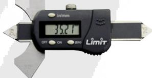
**Digital.** Para medición de juntas de soldadura plana y en esquina. Graduación en mm y pulgadas. Altura 10 mm. Precisión ± 0,03 mm. Resolución 0,01 mm. Altura de las figuras 8 mm. Apagado automático. Pilas 1,5V tipo SR44.
