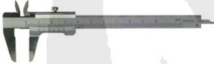
En acero. Cromado escala mate. Graduado en milímetros y con calibrador para 1/20 mm. Con medidor de profundidad y puntos para medición interna. DIN 862.
