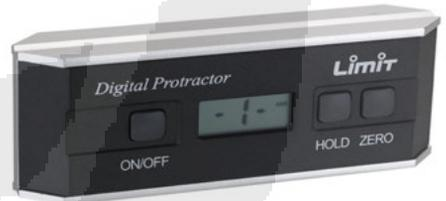
Nivel de burbuja y medidor de ángulo digital. Magnético con ranura en forma de V en la base. Se puede resetear en todas las posiciones. Función absoluta, que significa que el valor puede cambiar entre el valor real 0 y un segundo valor 0. Se puede mantener la medición en la posición deseada. Apagado automático. Pilas 3V tipo CR 2032.
