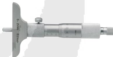
Lectura 0.01 mm. Con 4 varillas intercambiables en tramos de 25 mm. Casquillo y tambor graduado chapados en cromo mate. DIN 863.
