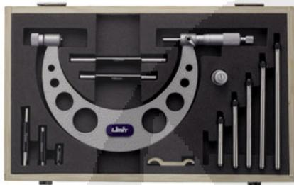
Lectura 0,01 mm. Morzada de acero esmaltado y escala chapada en cromo mate. Pernos insertados intercambiables 8,0 mm. Con superficies de medición pulidas de metal resistente. Casquillo de fricción y llave de bloqueo. DIN 863.
