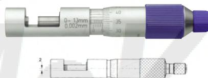
Escala cromada. Husillo endurecidos 6,5 mm con caras de medición pulido fino de metal duro. Manguito de fricción y tuerca de bloqueo. DIN 863.
