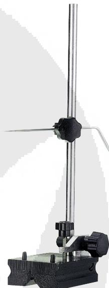
Base pesada con ranura inferior en forma de V. La base cuenta con dos pernos de guía. El eje está montado sobre un balancín dotado de un tornillo para el ajuste fino. Incorpora dos puntas de acero, una recta y otra doblada.
