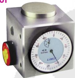
Dispositivo para posicionar herramientas en fresadoras, etc. El display muestra el movimiento de la superficie. "0" es la distancia de 50 mm. La base magnética facilita el ajuste vertical u horizontal. El dispositivo incorpora un mecanismo de calibración integrado. Dimensiones 50 x 50 mm.
