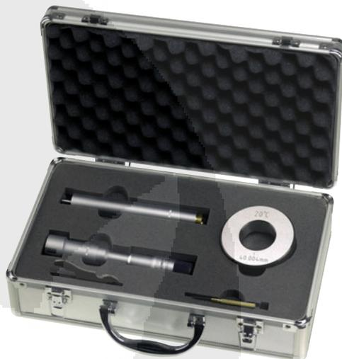
Con dispositivo de fricción, que da una fuerza de medida constante, y dispositivo de medición autocentrante. Superficies de medición de metal duro. Los pernos de medición alcanzan 0,5 mm desde el fondo de un agujero ciego. Anillo graduador incluido.
