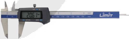
Acero inoxidable. Lectura 0,01 mm. Regulable entre mm y pulgadas. Con botón de reinicio. Apagado automático. DIN 862. Pilas 3 V tipo CR2032.
