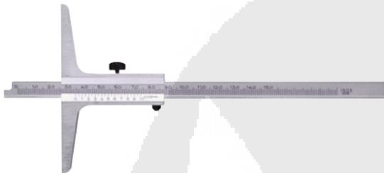
Acero inoxidable. Pie de rey vernier chapado en cromo mate y escala en brillo. Puntas y base de medición pulidas. Graduado en mm y pie de rey 1/20 mm. DIN 862.
