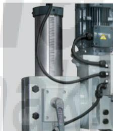
**Regulación en altura del cabezal**
