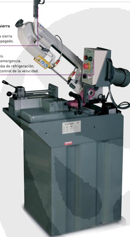
Sierra de cinta para metal con arco giratorio que permite variar la velocidad de forma continua.
