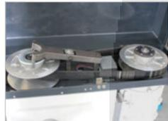
**Sistema mecánico de variación continua de la correa, ajustando el potencial de energía exactamente a la velocidad necesaria.**
