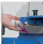
Fácil y rápida sustitución de la banda de lijado sin herramientas mediante una palanca de accionamiento optimizado.
