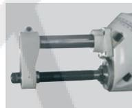
Cojinete de fricción regulable para trabajos de fresado en posición horizontal con luneta de protección y con sujeción para fresa de disco.
